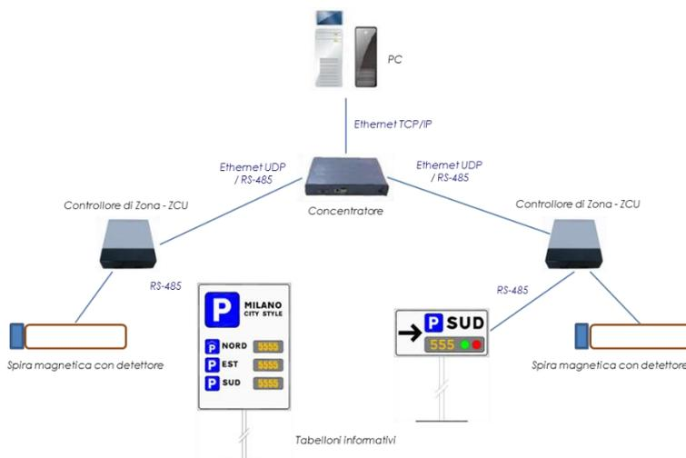
L'architettura è costituita da un insieme di sensori di rilevamento masse metalliche (spire a induzione magnetica) posizionate nei varchi di accesso e di uscita alle aree di sosta e sono collegate, tramite apposito detettore, all'elettronica di gestione (Controllore di Zona o ZCU).
